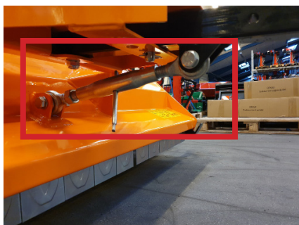
Højdejustering af klipperen
