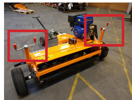
Højdejustering af baghjul / og højre/venstre montering
