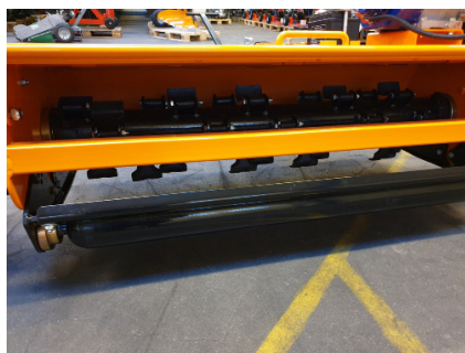
Bagrullen til højdejustering
